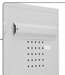
Fixation au mur possible grâce aux trous situés au dos de l'armoire tout en permettant la ventilation naturelle à l'intérieur de chaque case. Surface d'aération : 12,5 cm 2 (5x5 trous de Ø 7 mm)
