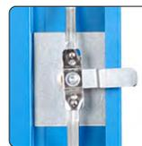
Fermeture 3 points : elle est composée d'une serrure à came multipoints et d'un système à tringles. En verrouillant la fermeture, elle actionne les 3 points de condamnation de la porte (haut, milieu et bas), offrant ainsi une sécurité maximale.
